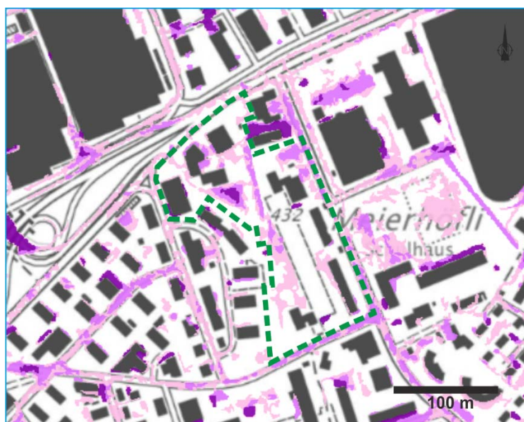
Abb. 3 Ausschnitt aus der Hinweiskarte Oberflächenabfluss. Kartengrundlage © KANTON LUZERN, RAWI (2024). Massstab: 1:5'000. Grün umrahmt: Projektperimeter.
