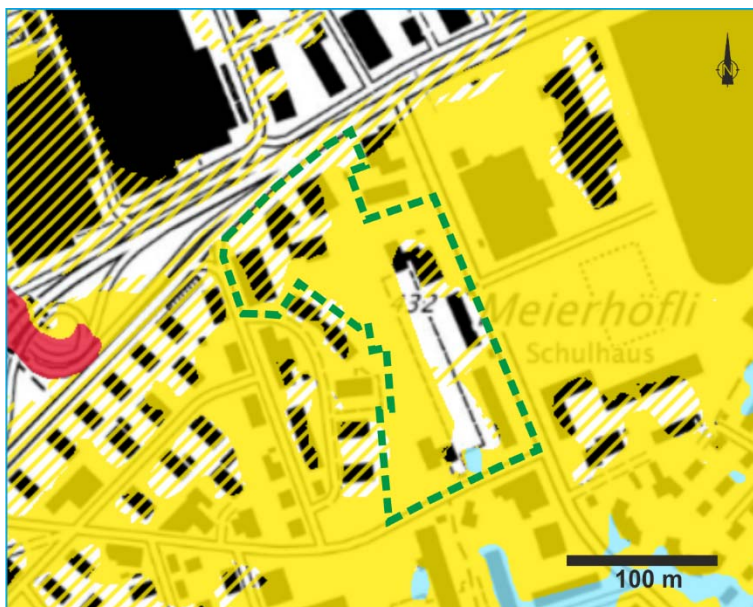
Abb. 2 Ausschnitt aus der Gefahrenkarte Wasserprozesse, Kartengrundlage © KANTON LUZERN, RAWI (2024). Massstab: 1:5'000. Grün umrahmt: Projektperimeter
