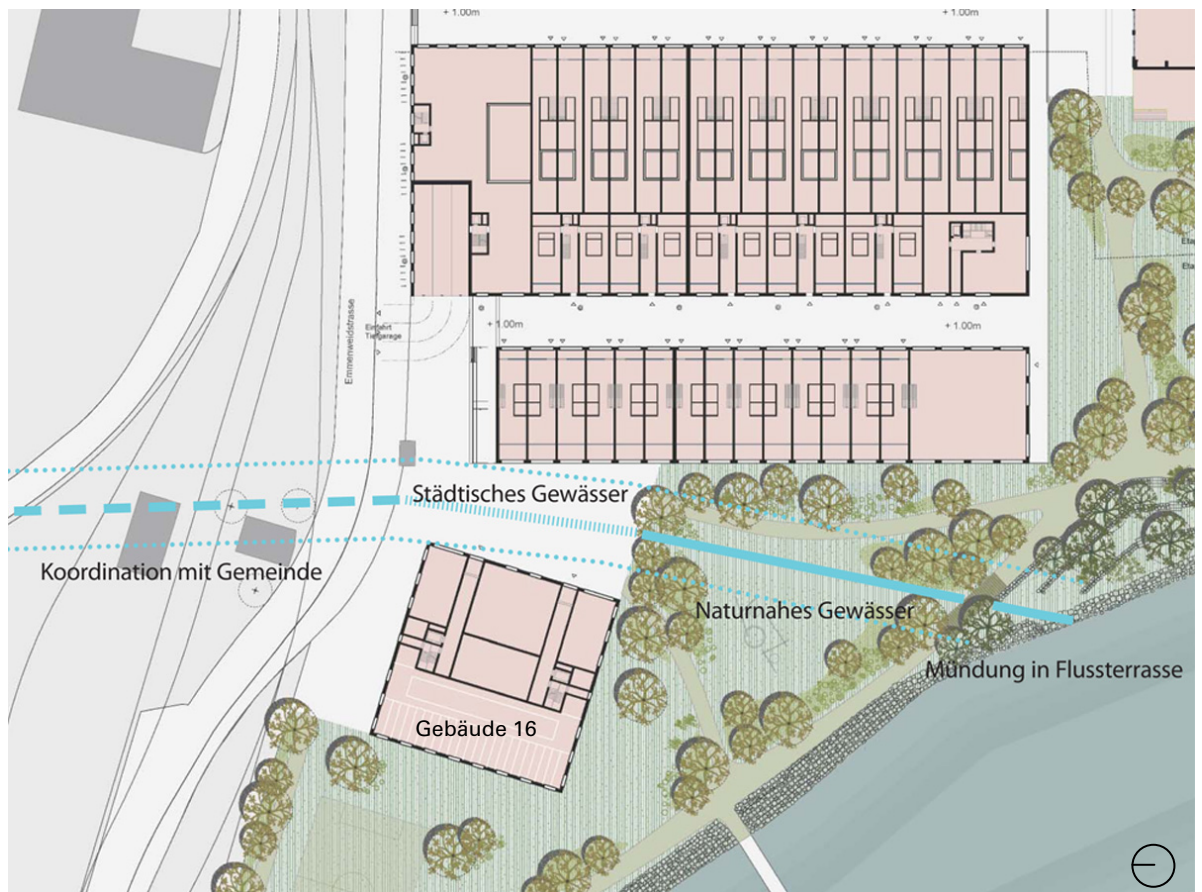
Abb.: Übersichtsplan Verlegung Schossbach
