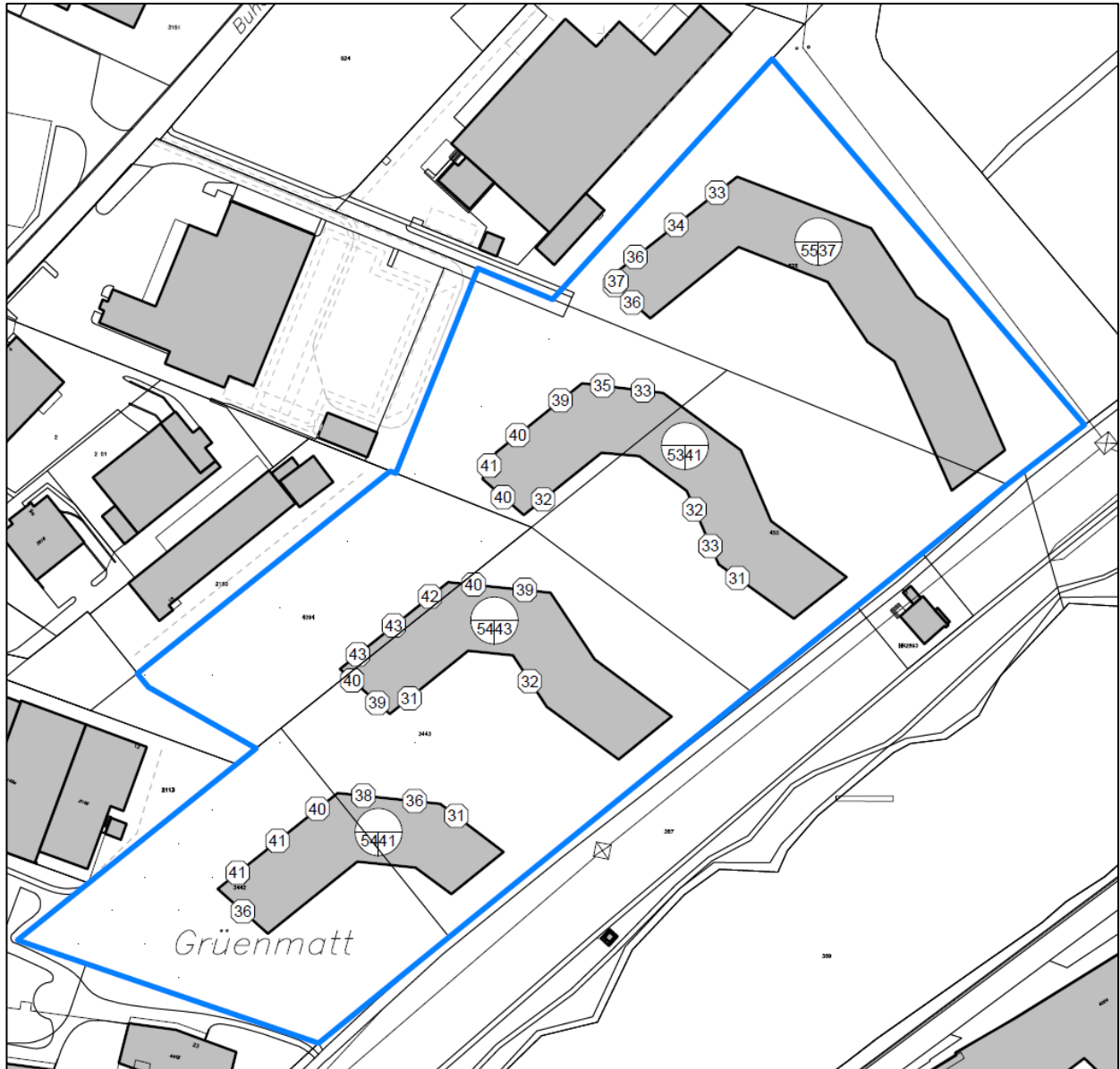
Abbildung 16: Gesamtlärm-Belastung nachts: Baubereiche
