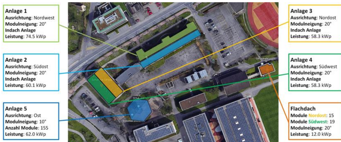
Abbildung 6; Solaranlage Schulanlage Gersag
